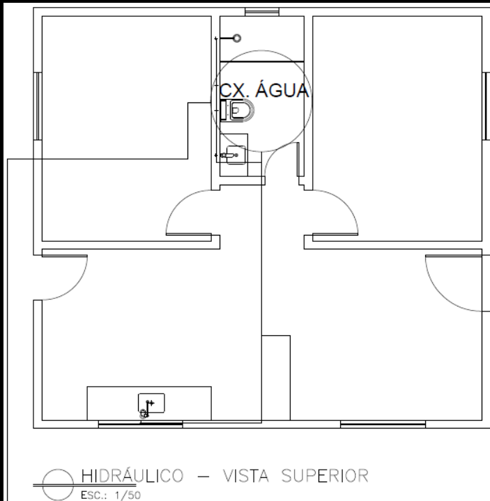
Figura 6 – Plantas da Casa Project : Hidráulico e Hidrossanitário
