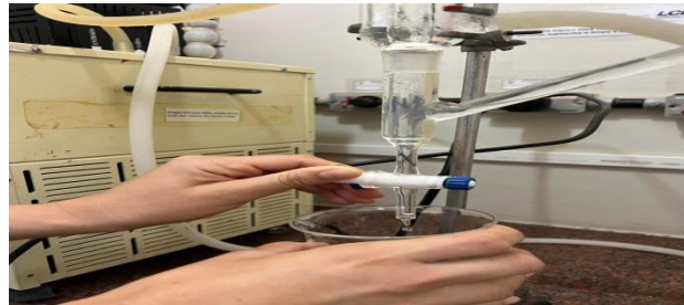
Figura 3 - Óleo sendo retirado do hidrodestilador
