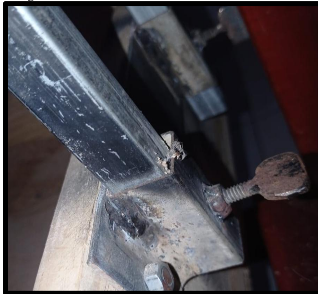
Figura 22 - Base da estrutura fixada na caixa de madeira
