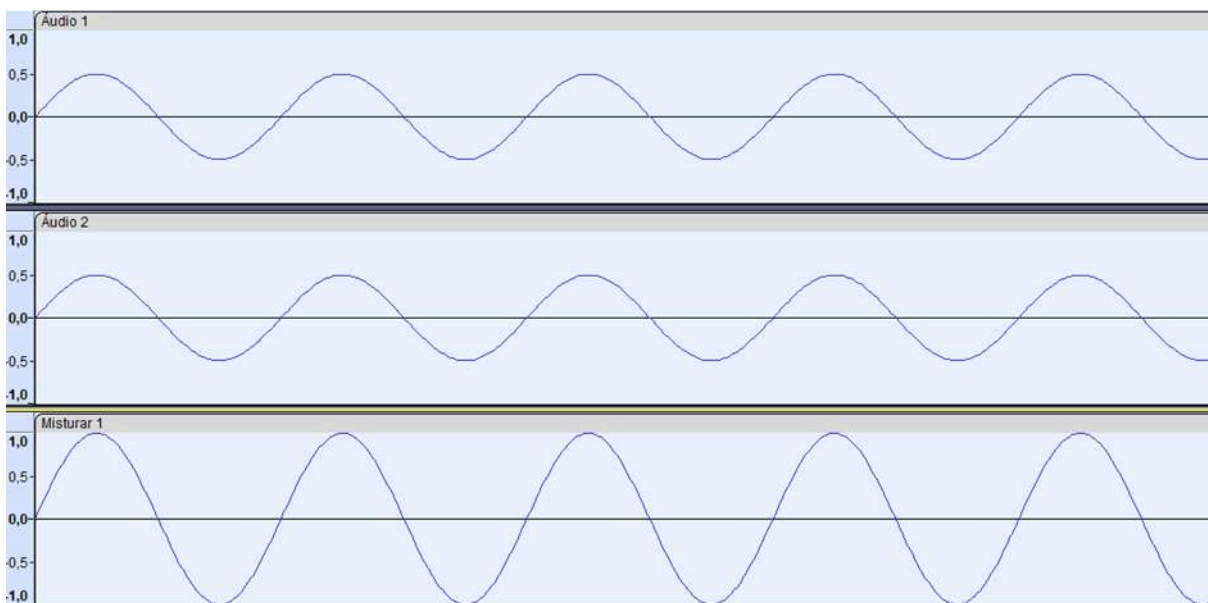
Figura 10 - Interferência construtiva em faixas idênticas de 440 Hz (int. 1,0).
