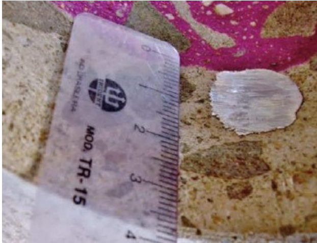
Figura 3. a. Profundidade de carbonatação medida com indicador de pH e b. Pilar com armadura exposta por efeito de corrosão (LIBERATI, 2014).
