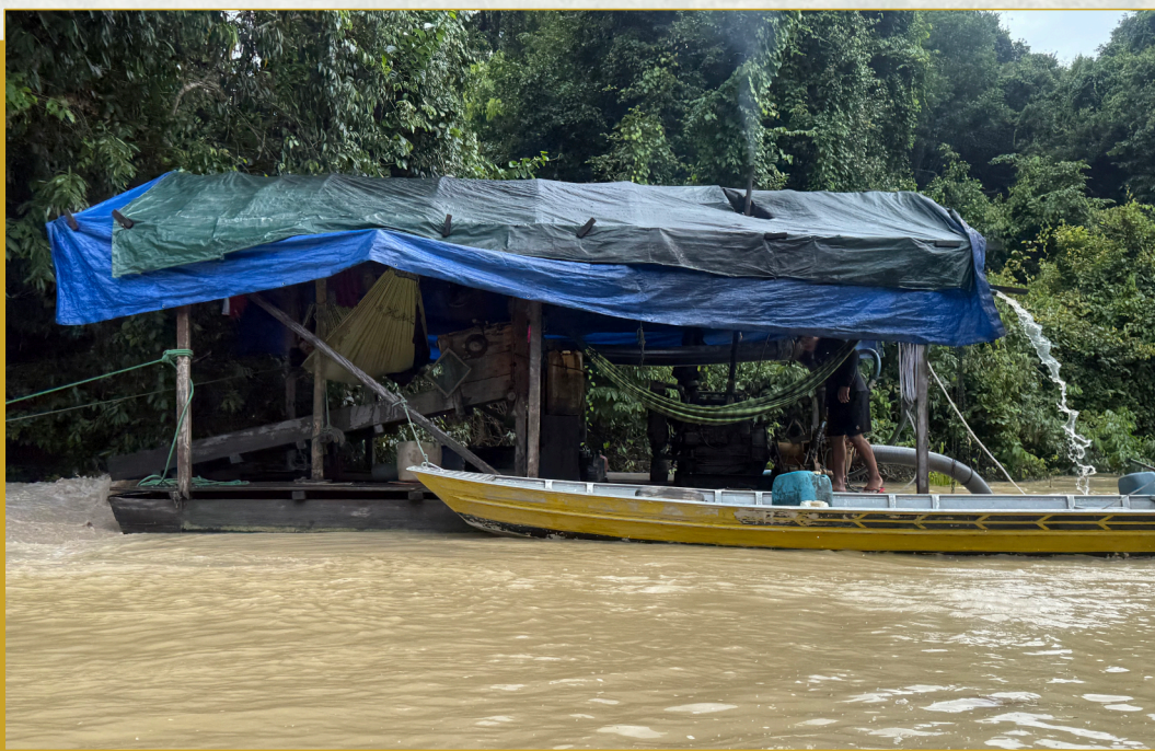
Balsa com bomba para dragagem de sedimento aluvial utilizada por garimpeiros no Rio Pacu, nas proximidades da Currutela São José, Jacareacanga-PA.
