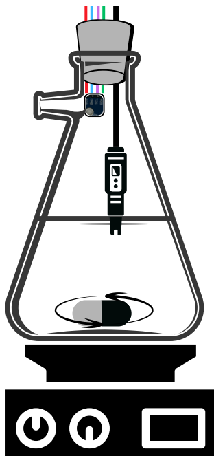
Figura 46: Representação do sistema sendo agitado com a barra magnética. Fonte: Autoria própria.
