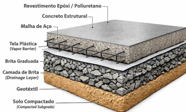
Figura 2. Esquema das camadas do piso industrial de concreto moldado in loco sobre o solo
