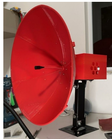
(b) Protótipo completo do nó sensor IoT acústico após a integração dos módulos
