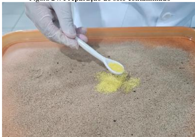
Figura 24: Preparação do solo contaminado
