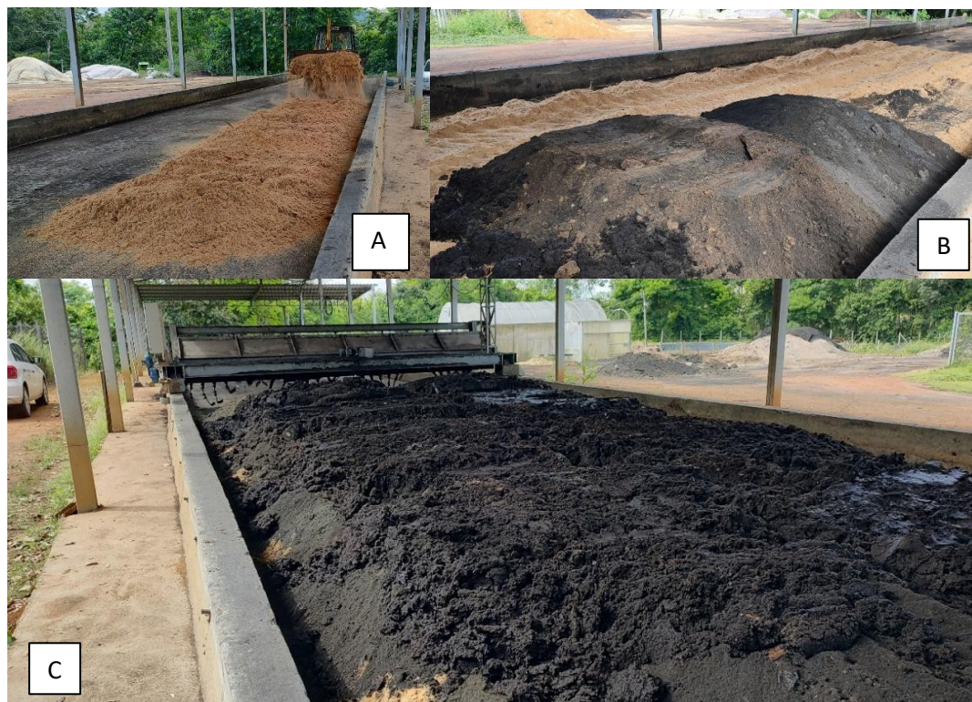
Figura 2. Processo de preparo da pré-compostagem com maravalha, cinza e lodo de café solúvel. A: Adição de maravalha; B: Adição de cinza por cima da maravalha; C: Adição de lodo da indústria de café solúvel.
