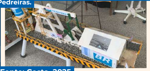
Figura 31 – Sistema de Bombeio Mecânico (BM), funcional, construído no IFMA - Pedreiras.
