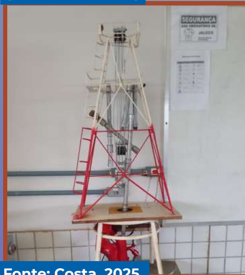
Figura 33 – Sonda de perfuração com sistema de rotação funcional e coluna montável (IFMA - Pedreiras)
