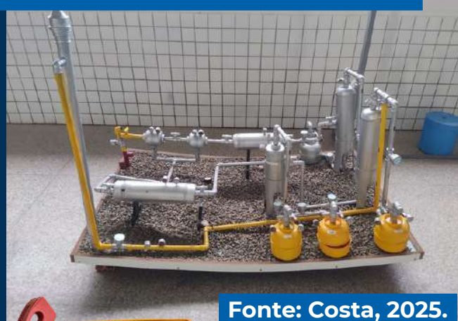
Figura 28 – Unidade de Processamento de Gás Natural (UPGN), construída em Projeto Maker no Curso Técnico em Petróleo e Gás do IFMA - Pedreiras
