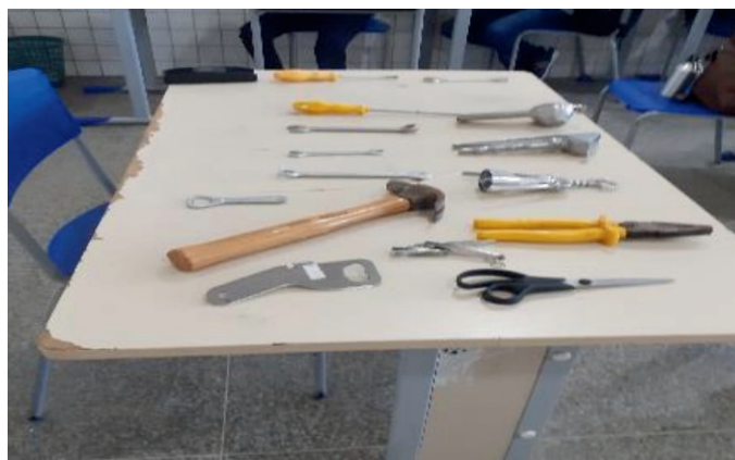
Figura 6 - Exposição de máquinas que usam o princípio da alavanca.
