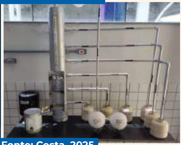
Figura 25 – Torre de Destilação de Petróleo construída por alunos do Curso Técnico em Petróleo e Gás do IFMA - Pedreiras
