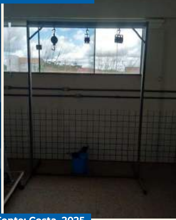
Figura 26 – Sistema de polias para estudo de movimentação de cargas no IFMA - Pedreiras
