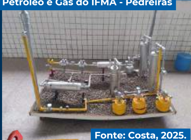
Figura 28 – Unidade de Processamento de Gás Natural (UPGN), construída em Projeto Maker no Curso Técnico em Petróleo e Gás do IFMA - Pedreiras
