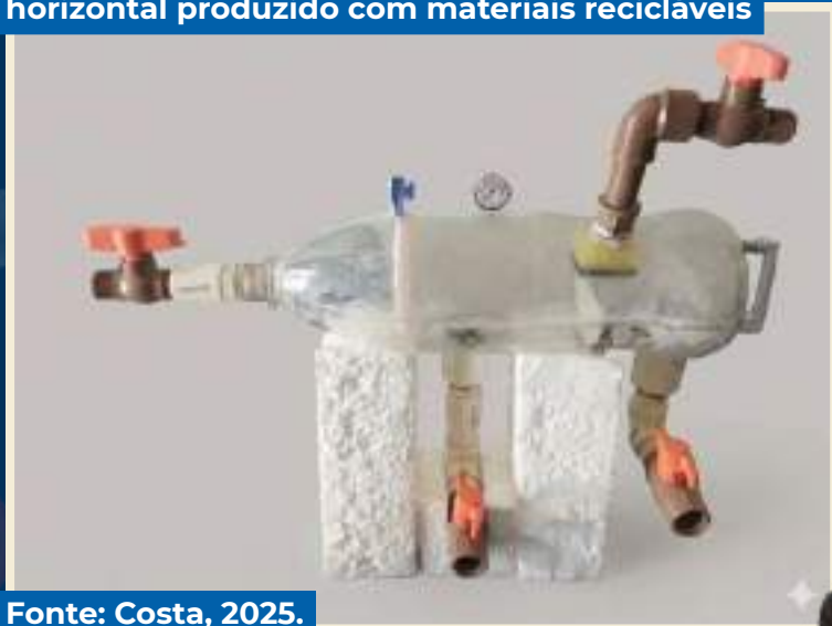
Figura 27 – Protótipo de separador trifásico horizontal produzido com materiais recicláveis
