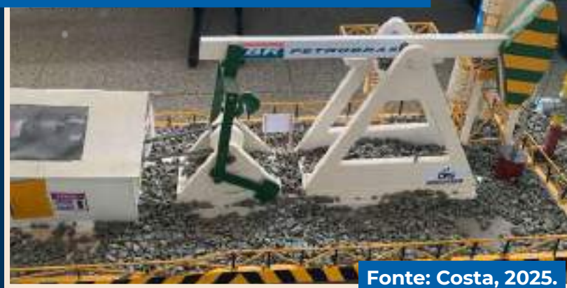
Figura 34 – Sistema de Bombeio Mecânico (BM) funcional construído no IFMA - Pedreiras
