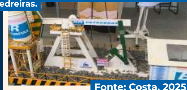
Figura 32 – Sistema de Bombeio Mecânico (BM), funcional, construído no IFMA - Pedreiras.
