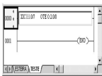
Figura A.4 - Programação ladder por linhas de instruções
