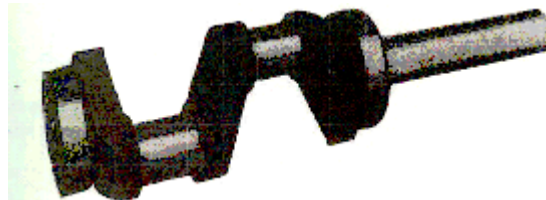
Eixo de manivelas do compressor Worthington com seus respectivos mancais fixos de rolamento.
