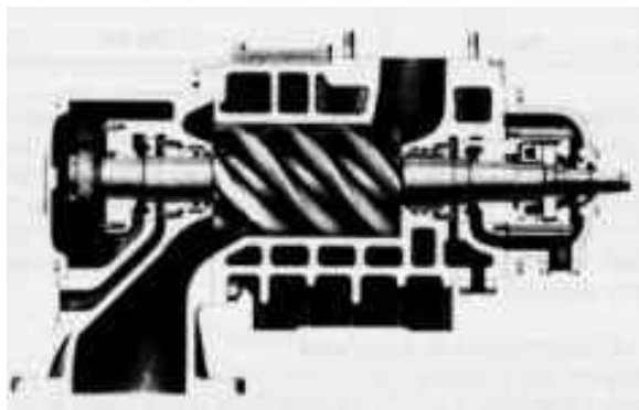
Vista lateral indicando a movimentação do gás em um compressor de parafusos.
