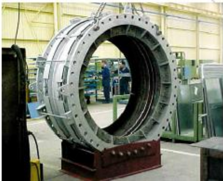
Figura 2.24 – Junta de Expansão para linha de ar quente ( T = 1300^{\circ}\text{C} ).
