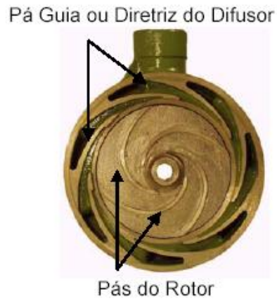
Figura 4.3 - Caracol de descarga centralizada com difusor fixo.
