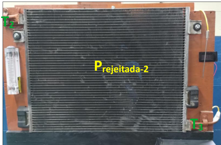
Figura 6 - Foto frontal do radiador colmeia. P_{rejeitada-2} : Potência rejeitada pela colmeia
