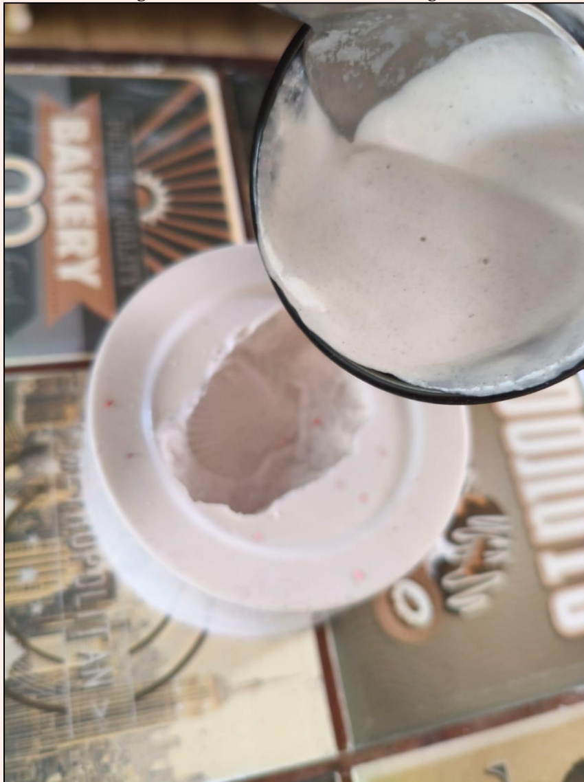
Figura 28: Preenchendo o molde com gesso
