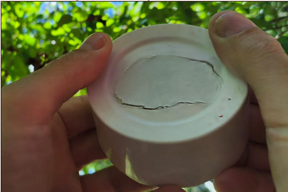
Figura 30: Retirada da réplica de fóssil do molde
