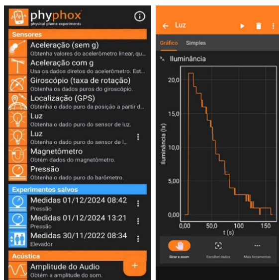
Figura 07: Em (a) e interface do aplicativo Phyphox com destaque ao experimento Luz e em (b) o gráfico gerado com os dados coletados pelo aplicativo durante o experimento. Acervo dos autores
