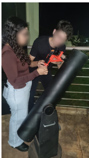
Figura 06: Pesquisadores observando a passagem da Lua cheia com o uso do setup (telescópio, suporte, smartphone e aplicativo) – Fonte: Acervo dos autores
