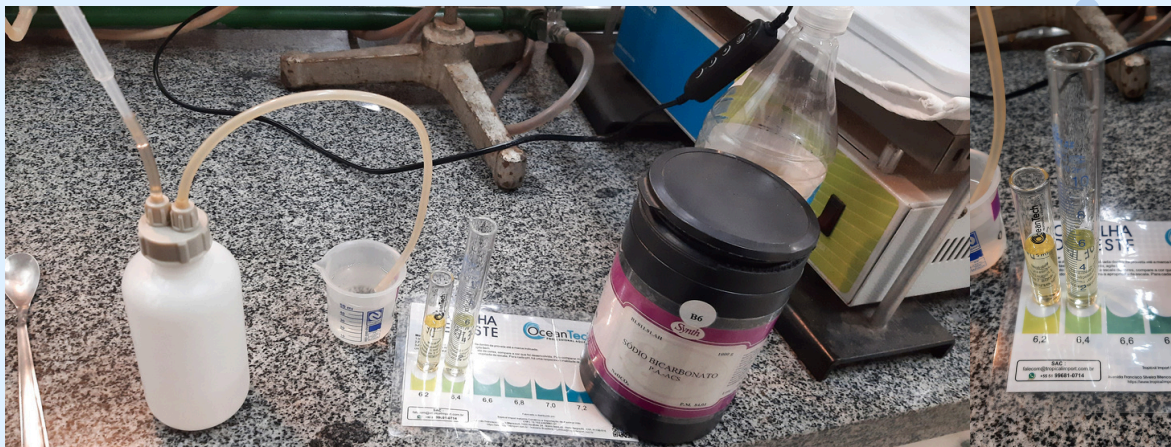
Figura 2. Montagem do experimento de acidificação das águas oceânicas. (Elaboração: Marcela B. da Cunha-Santino e Irineu Bianchini Júnior)
