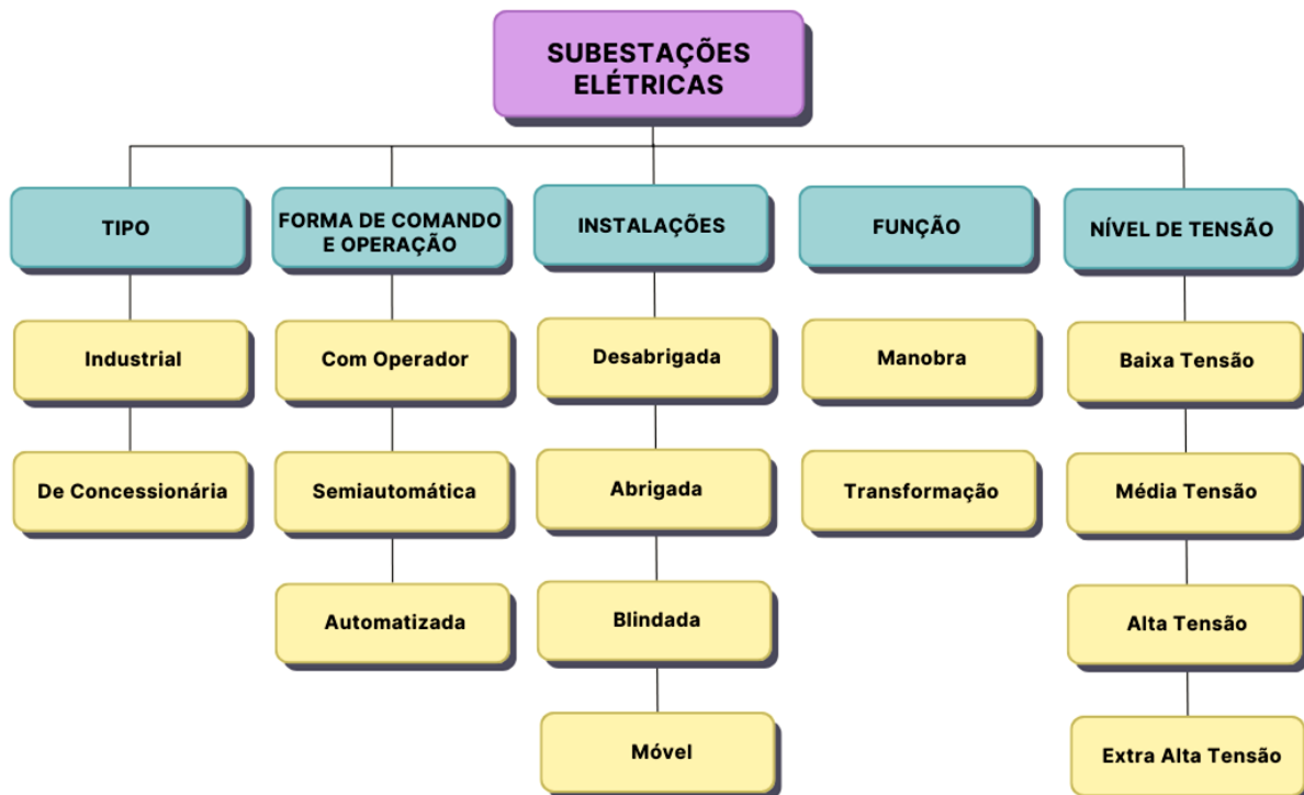
Figura 3 – Classificação das Subestações.
