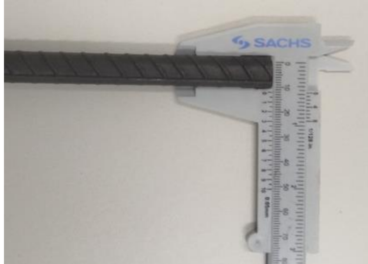
Figura 1 – Registro do vergalhão do aço CA investigado.
