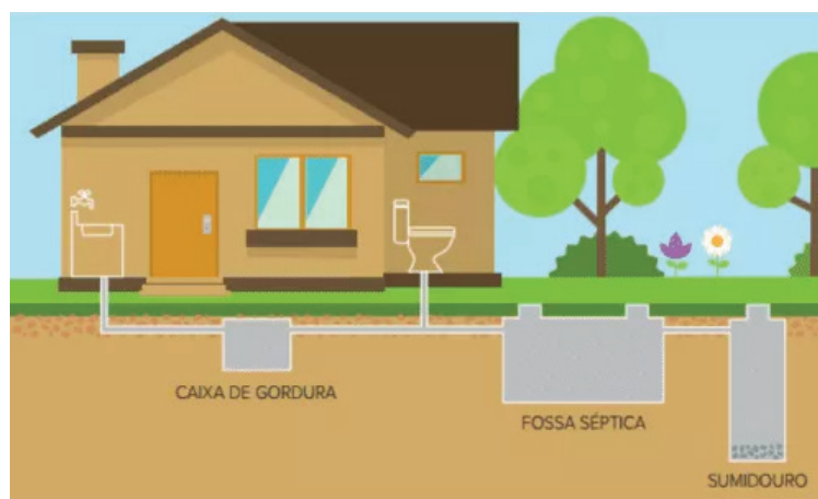
Figura 36 – Solução individual de esgotamento sanitário
