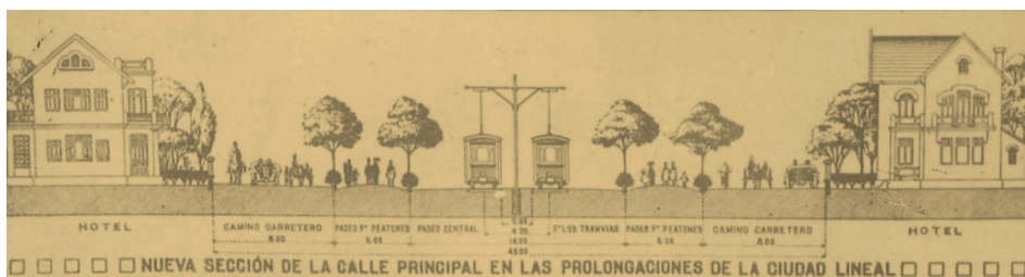
Figura 10 – Seção transversal da avenida principal do projeto de cidade linear de Arturo Soria
