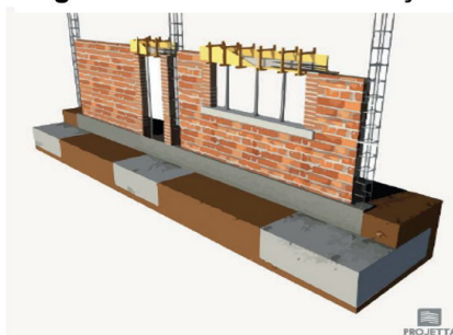
Figura 19 - Alvenaria de vedação
