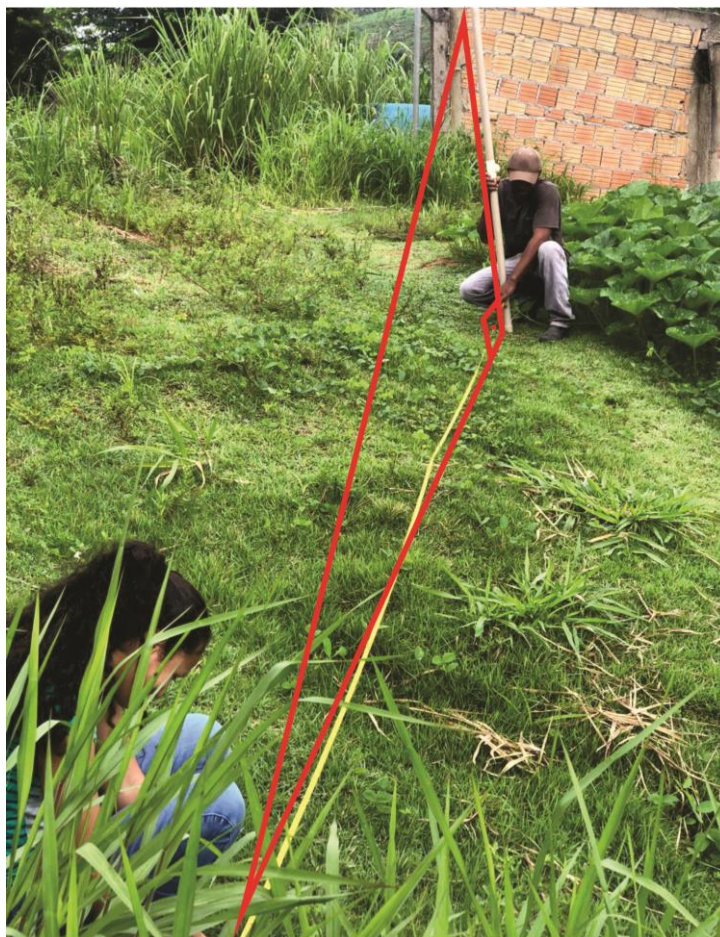
Figura 24 – medindo distância até a estaca
