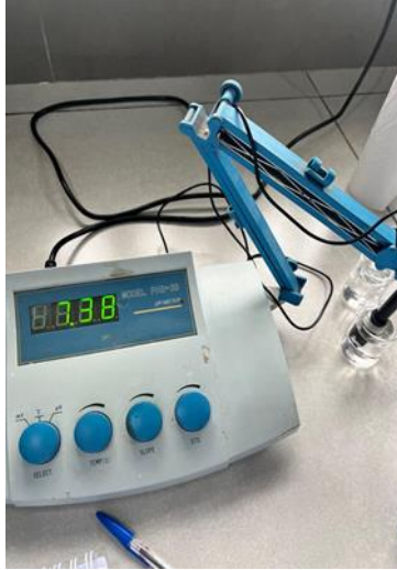
Figura 03: pHmetro de bancada
