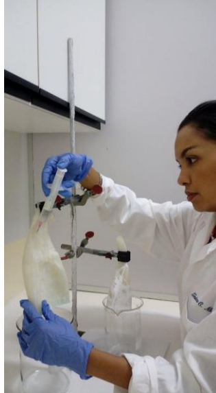
Figura 5 – Resina epóxi tecido equivalente sendo injetada no molde de músculo 3D para preenchimento.
