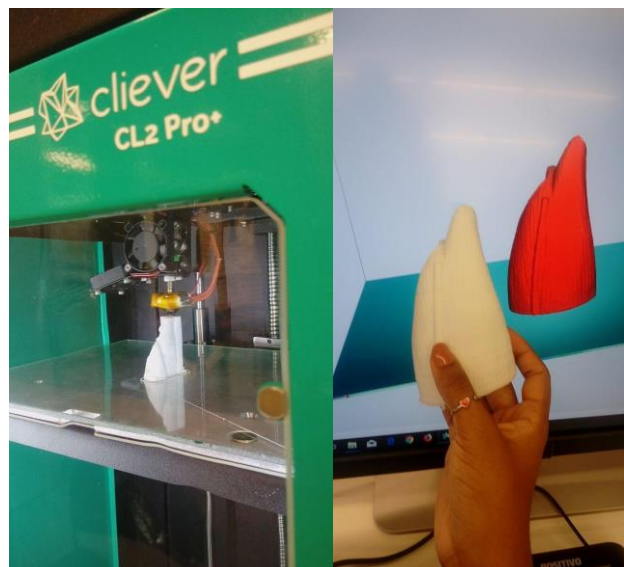
Figura 4 - Impressão das partes da articulação: à esquerda: durante a impressão; à direita após a impressão, com a imagem no Software da Clever no fundo.
