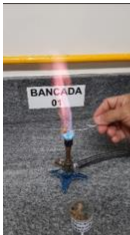
Figura 9: Chama violeta utilizando Bico de Bunsen identificando o elemento potássio a partir da Biomassa de Banana verde orgânica
