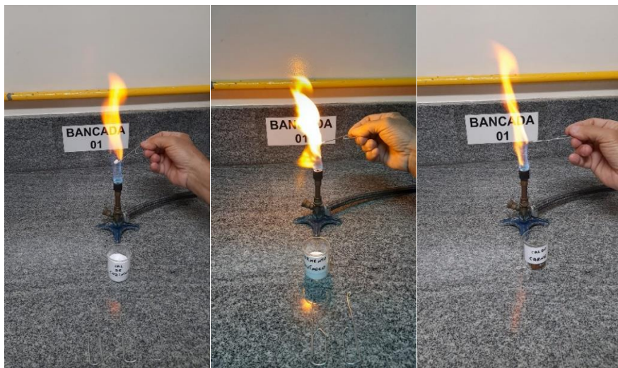
Figura 7: Chama amarela utilizando Bico de Bunsen identificando o elemento sódio a partir dos alimentos Sal de cozinha, Fermento químico e Tablete de Calde de carne, respectivamente.
