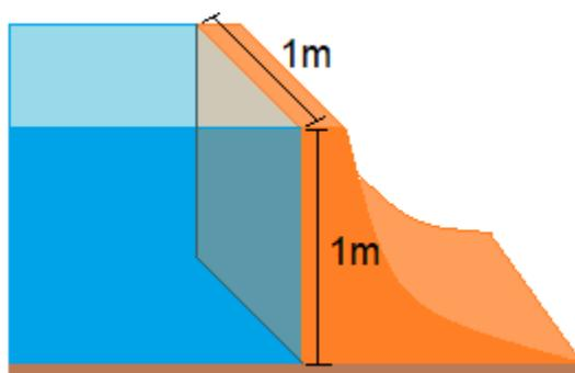
Imagine o quadrado dividido em 4 faixas horizontais e suponha que cada faixa sofra uma rotação de  $90^\circ$  em torno de seu lado superior, ficando sujeita ao peso da água situada sobre ela.
