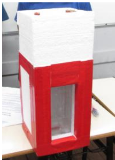
Figura 5: Geladeira com pastilha termopar, feita pelos alunos. [Fonte: próprio autor]
