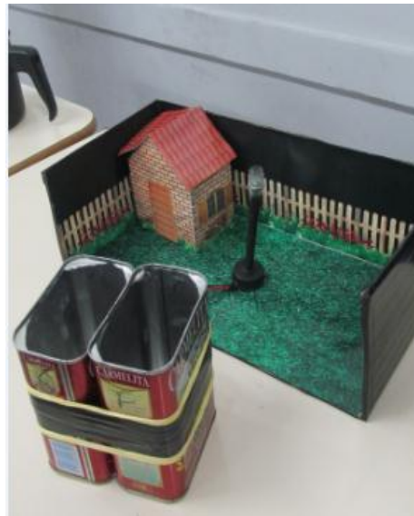
Figura 7: Gerador termoelétrico acendendo um led, feito pelos alunos. [Fonte: próprio autor]
