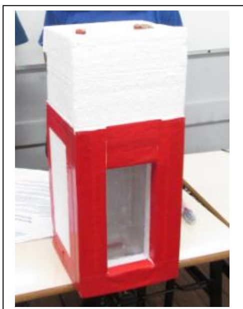
Figura 3.1: Geladeira com pastilha termopar, feita pelos alunos. [Fonte: próprio autor]
