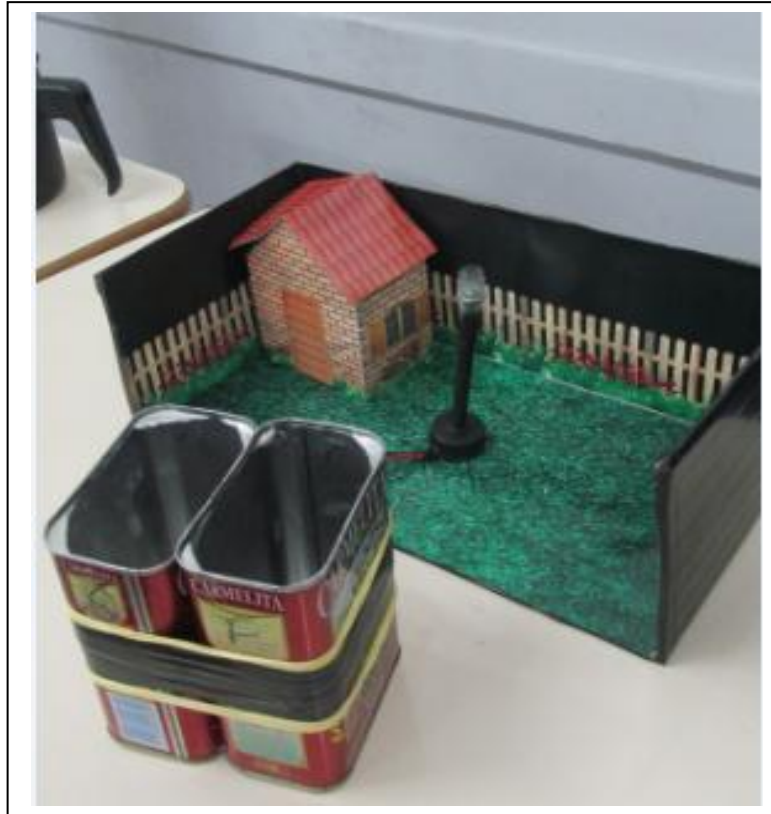
Figura 3.3: Gerador termoelétrico acendendo um led, feito pelos alunos. [Fonte: próprio autor]
