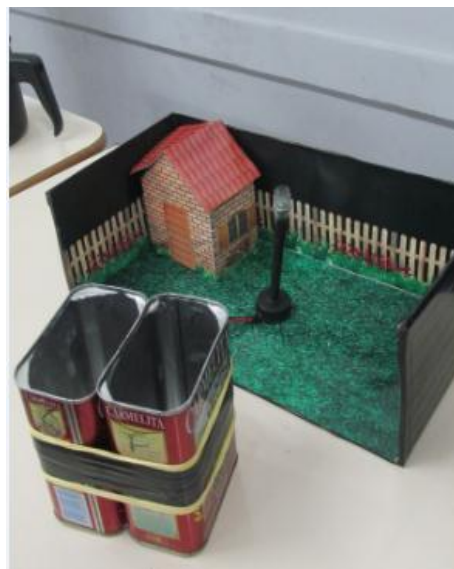
Figura 7: Gerador termoelétrico acendendo um led, feito pelos alunos. [Fonte: próprio autor]
