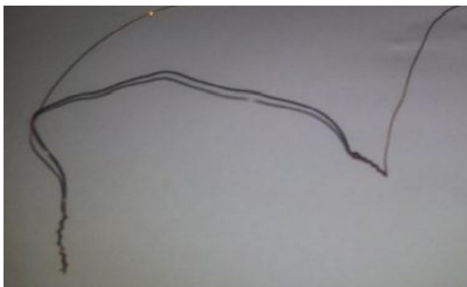
Figura.3: Termopar feito de cobre e arame [Fonte: KAKIMOTO, 2013, p. 8]
