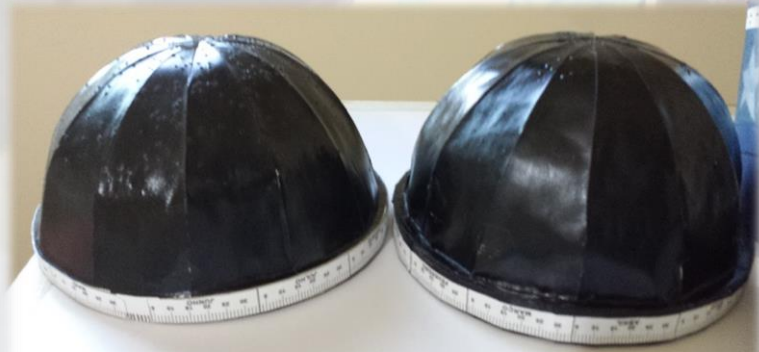
Figura 5: Exemplos de duas cúpulas externas montadas
