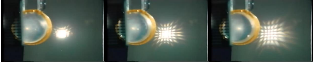
Figura 22: Na sequência, a imagem dos raios de luz, sendo focadas com o aumento da curvatura da lente artificial.
