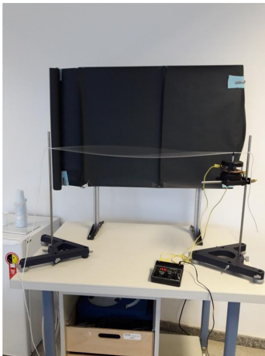
Experimento utilizado para evidenciar alguns dos modos de vibração de uma corda.
