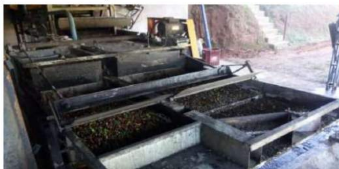
Figura 9 - Compartimento do despulpador de café que realiza a separação dos grãos através da diferença de densidade
