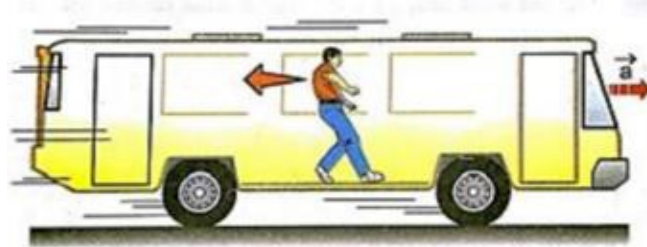
Figura 20: Um passageiro sendo projetado para trás quando um ônibus, inicialmente em repouso, acelera para frente.
