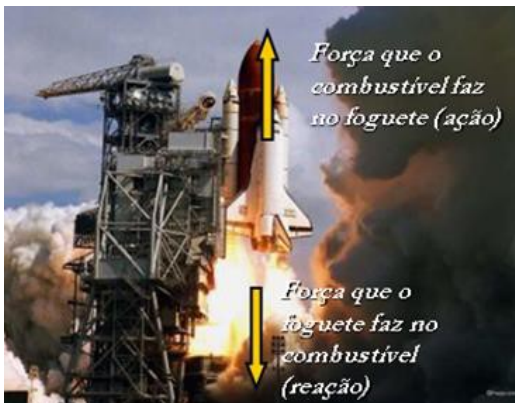
Figura 39: Forças de ação e reação no lançamento de um ônibus espacial.
