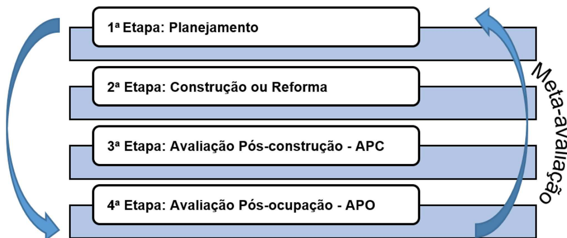
Figura 6 - Etapas da construção/reforma de edifícios de campus
