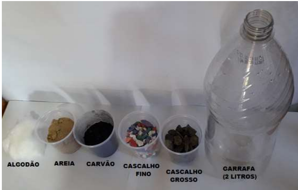
Figura 2: Materiais utilizados na atividade experimental 1: Como limpar a água.
